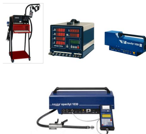
Slika 1: Uređaji koji se koriste za ispitivanje izduvnih gasova na stanicama tehničkog pregleda u Federaciji BiH
