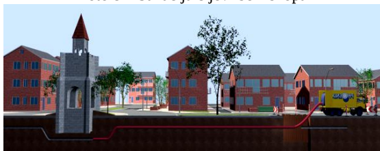
Foto 8 – Sanacija cijevi bez iskopa
