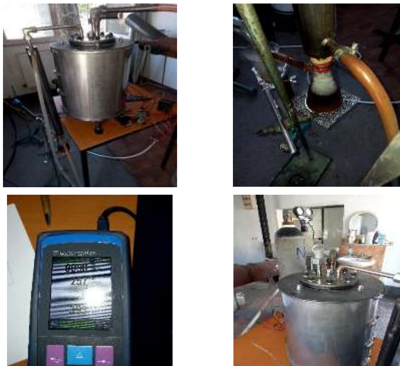
Slika 3.3. Fotografski prikaz peći za pirolizu, posudu za prihvata kondenzata i gasni analizator
