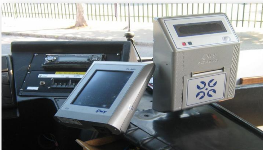
Slika 2. Stabilni aparat TA 400 s terminalom BT3 u vozilu[2]
