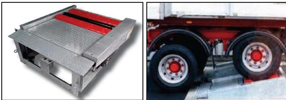
Slika 1: Oprema za kontrolu ispravnosti sistema za zaustavjanje prikolica i poluprikolica
