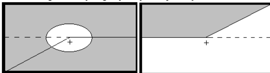
Slika 3: Usmjerenost dugog i oborenog svjetla kod vozila
