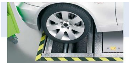
Slika1: pregled kočionih sila na valjcima
