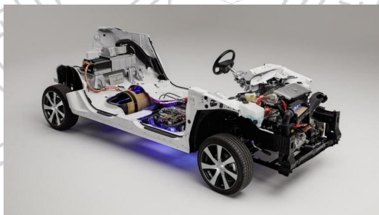
Slika 5: Presjek vozila sa gorivnim ćelijama (Izvor: https://autorepublika.com , 10.04.2023)
