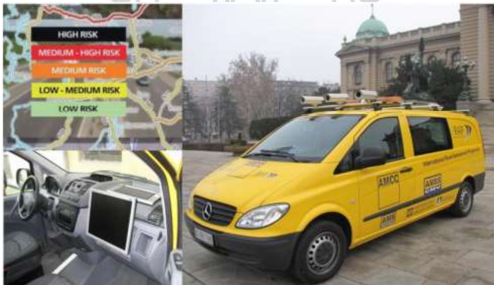
Slika 0-1: Vozilo i oprema koja se koristi za iRAP/EuroRAP metodologije
