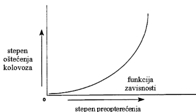
Slika 6: Odnos preopterećenja vozila i oštećenja kolovoza
