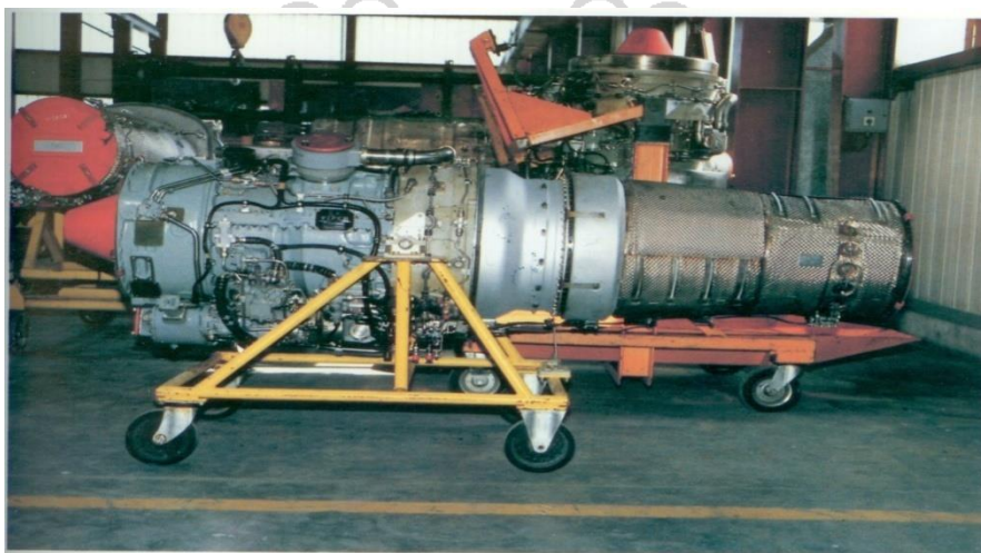
Slika 1. Izgled motora VIPER 632 – 46 [1,2]
