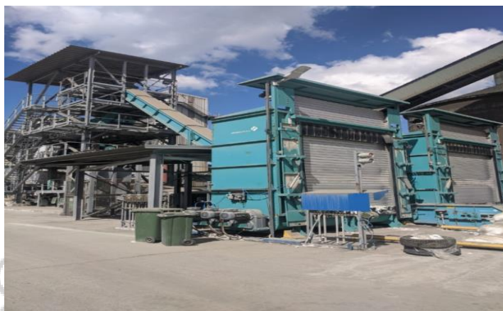
Slika 2. Pogon za prihvatanje i direktan transport RDF-a u rotacionu peć Interni izvor
