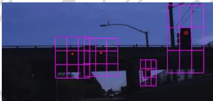
Detekcija svjetla na semaforima pomoću računarskog vida
