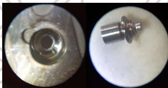
Slika 1. Oštećeni prelivni ventil i kućište ventila Bosch "0 445 115 024" brizgaljke 181
