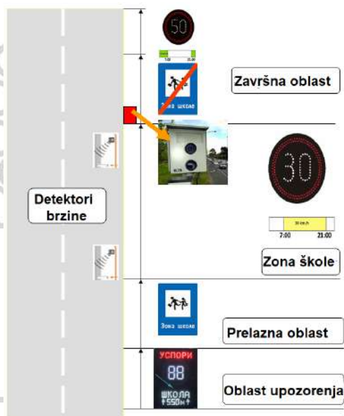
Slika 4. Plan uvođenja ITS-a za nadzor i upravljanje u zoni škole[6]
