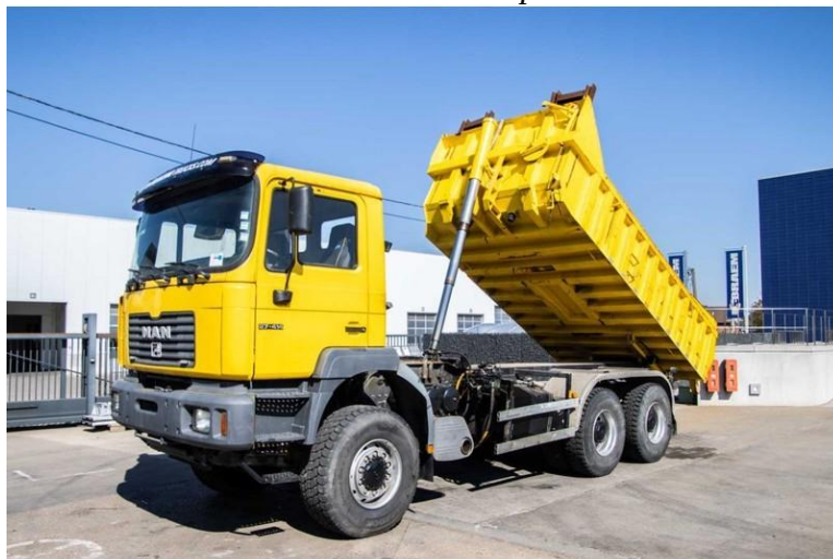
Slika 7. Primjer primjene teleskopskih cilindara
