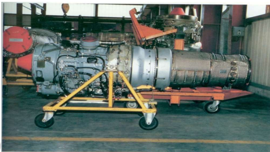
Slika 1: Izgled motora VIPER 632 - 46
