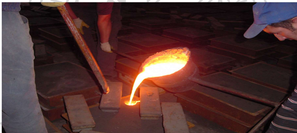
Slika.3. Izlijevanje taline iz lonca u kalupnike. "LIVNICA TEŠIĆ" Čatrnja
