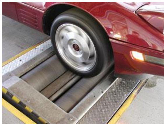
Slika 1. Testiranje kočnica Izvor: [ http://www.hak.hr , 2017.]
