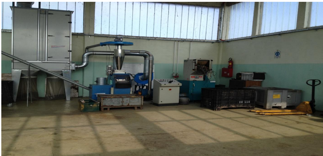
Slika 7. Mlin sa selektorom za elektronički otpad, kapaciteta 250 Kg/h.
