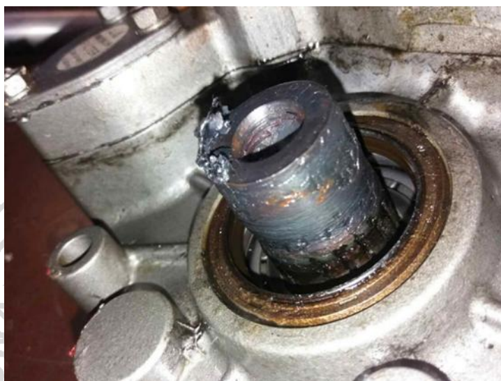
Slika 3. Oštećenje na kopči motora (Izvor: Autori 2018.)
