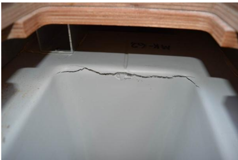
Slika 1. Oštećenje kobilice (Izvor: Autori 2018.)
