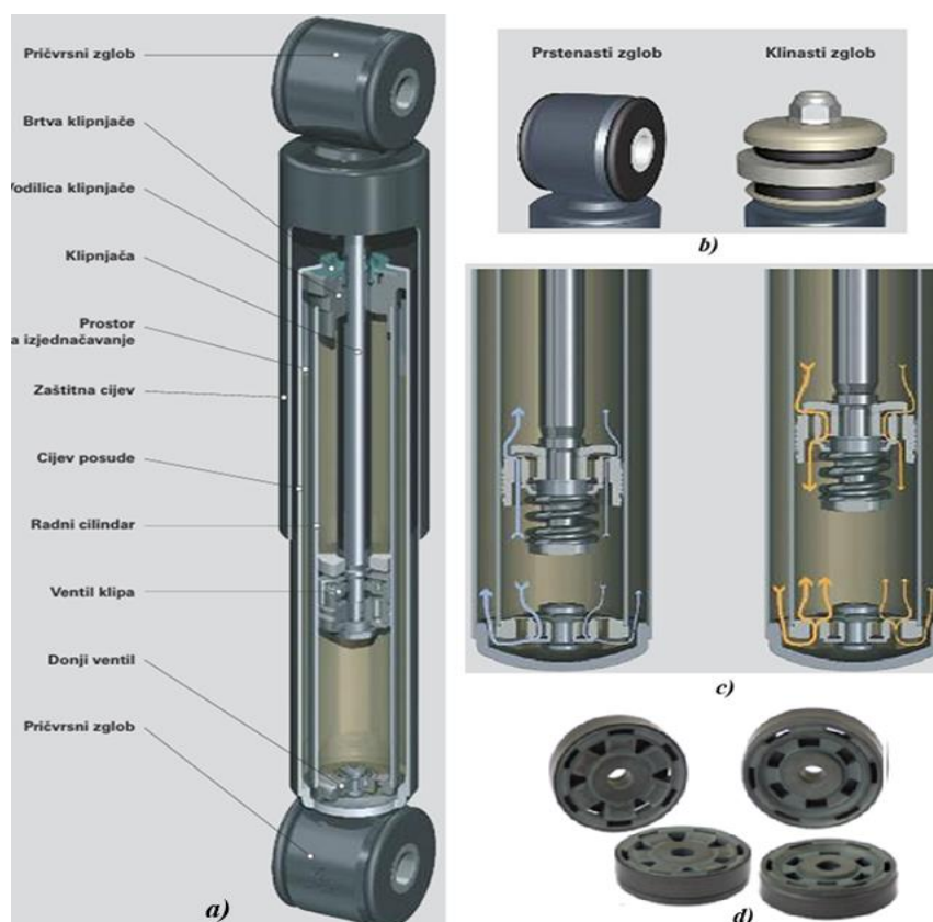
Slika 1. Dvocjevni hidraulički amortizer: a-šema, b-izvedbe oslonaca, c-lijevo: faza sabijanja, desno: faza razvlačenja, d-izvedbe klipova (Izvor: katalog SACHS 298 , prilagodio autor)
