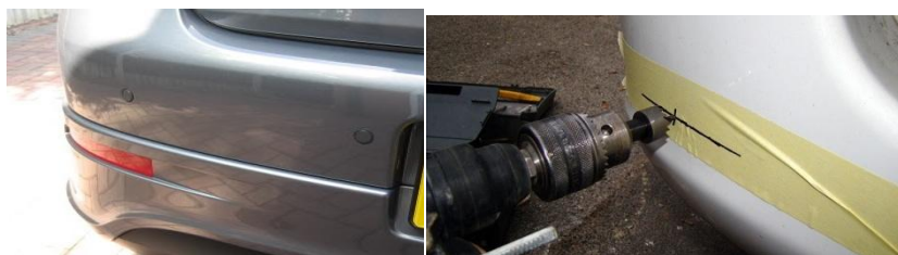
SLIKA 2. POSTAVLJANJE SENZORA ZA PARKIRANJE I VOŽNJU UNAZAD
