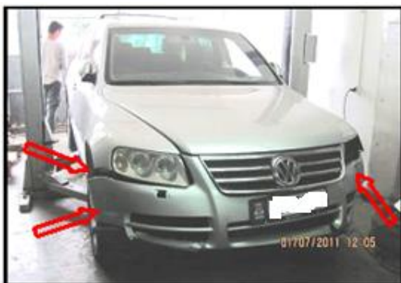
Slika 23. i Slika 24. Oštećenje prednjeg branika i „kidanje“ prednjeg branika [3]
