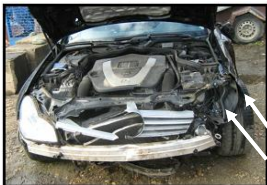
Slika 3. Prikaz oštećenja gornjeg lijevog „veznog držača“ [3]
