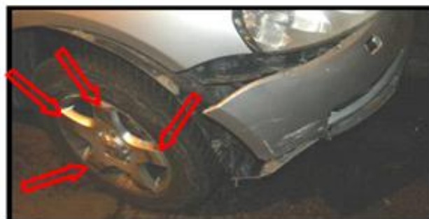
Slika 25. i Slika 26. Karakteristično oštećenje ukrasne plastike i Oštećenje naplatka prednjeg lijevog točka [3]
