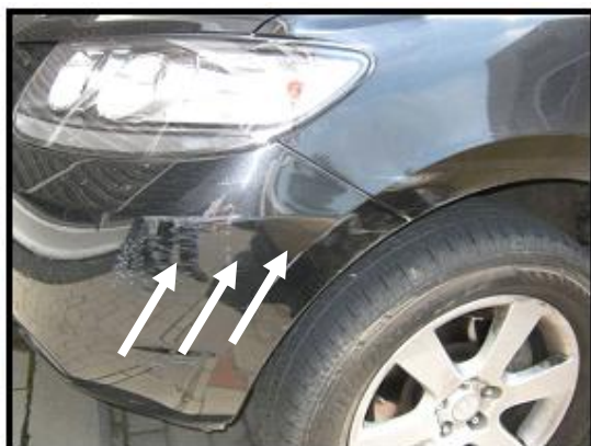
Slika 17. i Slika 18. Prikaz oštećenja prednjeg branika i trag grebanja [3]
