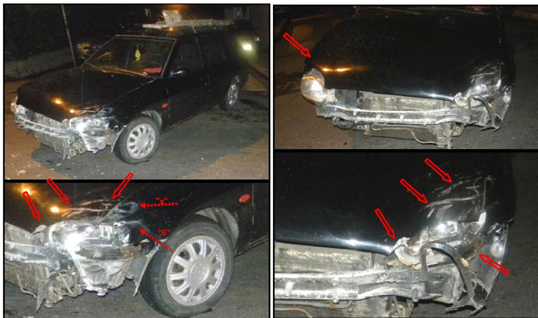
Slika 29. i Slika 30. Širi izgled oštećenja prednjeg lijevog blatobrana i bliži prikaz oštećenja prednjeg lijevog blatobrana [3]
