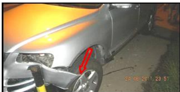
Slika 27. i Slika 28. Prikaz oštećenja naplatka prednjeg lijevog točka i naplatka zadnjeg lijevog točka
