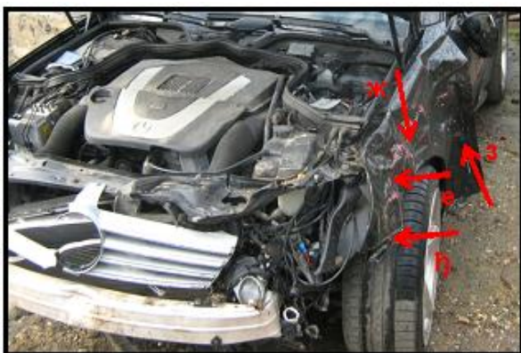
Slika 5. Prikaz detaljnog oštećenja lijevog blatobrana [3]
