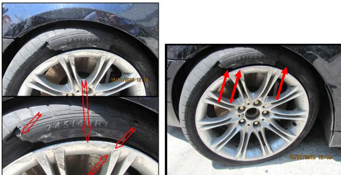
Slika 11. i Slika 12. Oštećenja pneumatika- „rascjep“ [3]
