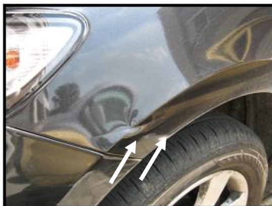
Slika 17. i Slika 18. Prikaz oštećenja prednjeg branika i trag grebanja [3]
