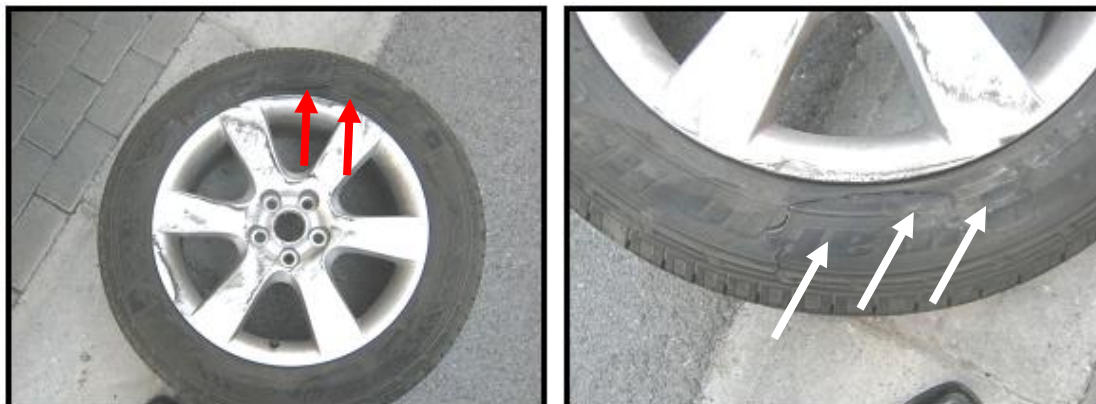
Slika 21. i Slika 22. Prikaz oštećenja pneumatika [3]
