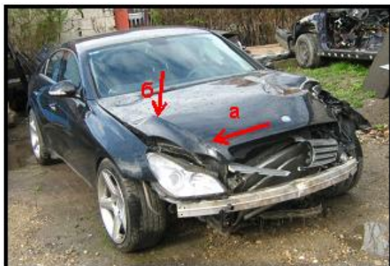
Slika 1. Širi izgled oštećenja poklopca motora [3] Slika 2. Prikaz oštećenja poklopca motora [3]
