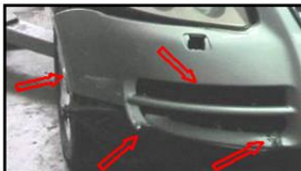
Slika 23. i Slika 24. Oštećenje prednjeg branika i „kidanje“ prednjeg branika [3]
