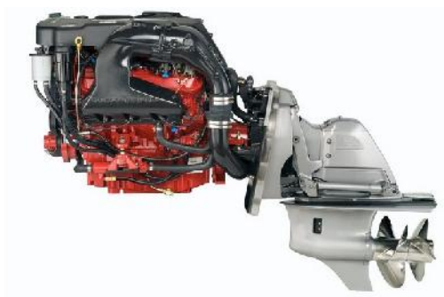
Slika 5: Volvo duoprop kontrarotirajući vijci [29]
