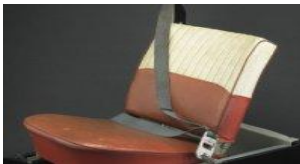
Slika 1. Prvi sigurnosni pojas sa tri oslonca vezanja Izvor: [ http://www.sigurnosnipojas.com ]
