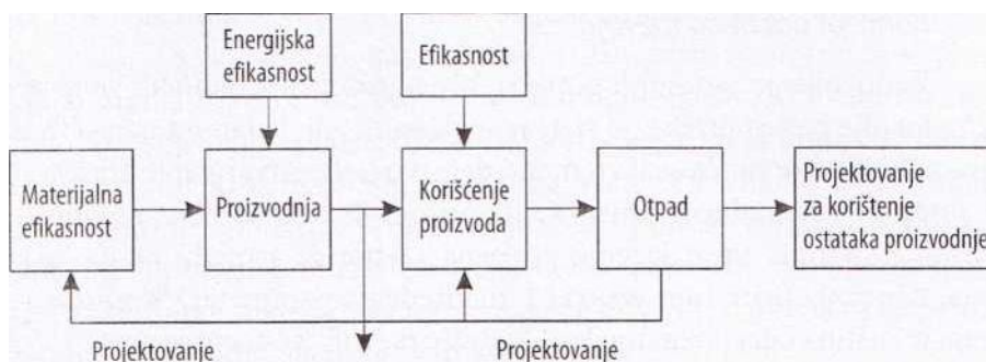
Slika 1 Blok dijagram materijalnih tokova u proizvodnom sistemu
